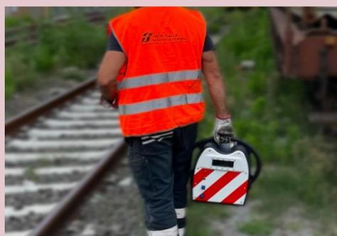
Il dispositivo si compone di due moduli, detti Slave e Master, che comunicano fra di loro trasmettendo segnali di avviso e allarme in relazione alla distanza rilevata da un probabile ostacolo in avvicinamento. L'Intelligenza Artificiale è in grado di rilevare la distanza da eventuali ostacoli/persona che si possono trovare sui binari e quindi invia una serie di avvisi luminosi e sonori che si differenziano in base ai range impostati.
