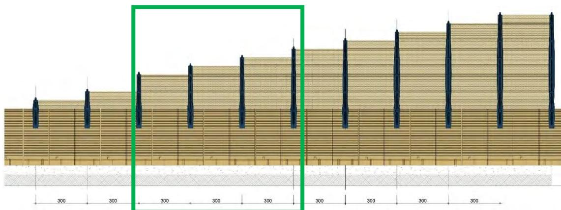
Figura 2-34 - Sezione tipologica delle barriere antirumore (in verde i moduli previsti per il presente progetto)
