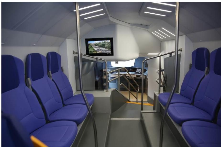
L'architettura del nuovo convoglio di Trenitalia per i pendolari è caratterizzata da casse in lega leggera, da una trazione a potenza distribuita, ossia con i motori posizionati lungo il convoglio e non alle sole estremità, e dalla massima ampiezza possibile di spazi e volumi a disposizione dei passeggeri.
