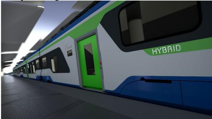
Il *Blues* viaggia con motori diesel su linee non elettrificate, con pantografo sulle linee elettrificate. Una tecnologia ibrida di nuova generazione che si traduce in migliori prestazioni, in una riduzione del consumo di carburante e in una forte riduzione in termini di emissioni di CO<sub>2</sub> rispetto agli attuali convogli diesel.
